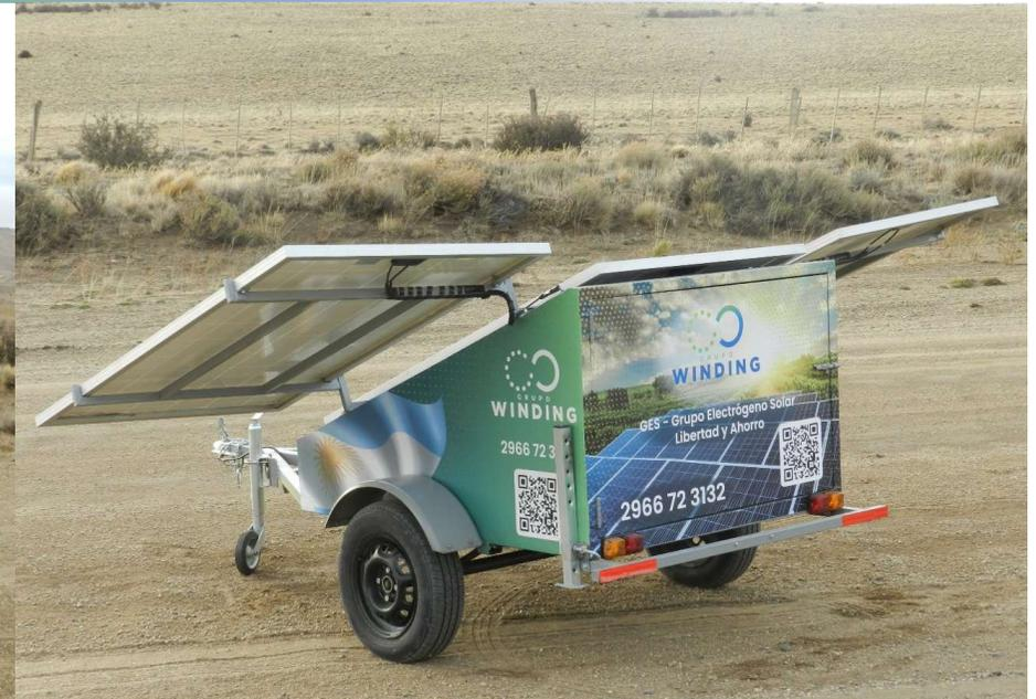
Este producto Winding es un tráiler **equipado con paneles solares, baterías, inversor y tablero de distribución eléctrica**, listo para conectarse al consumo de una vivienda, comercio u obra en construcción.
